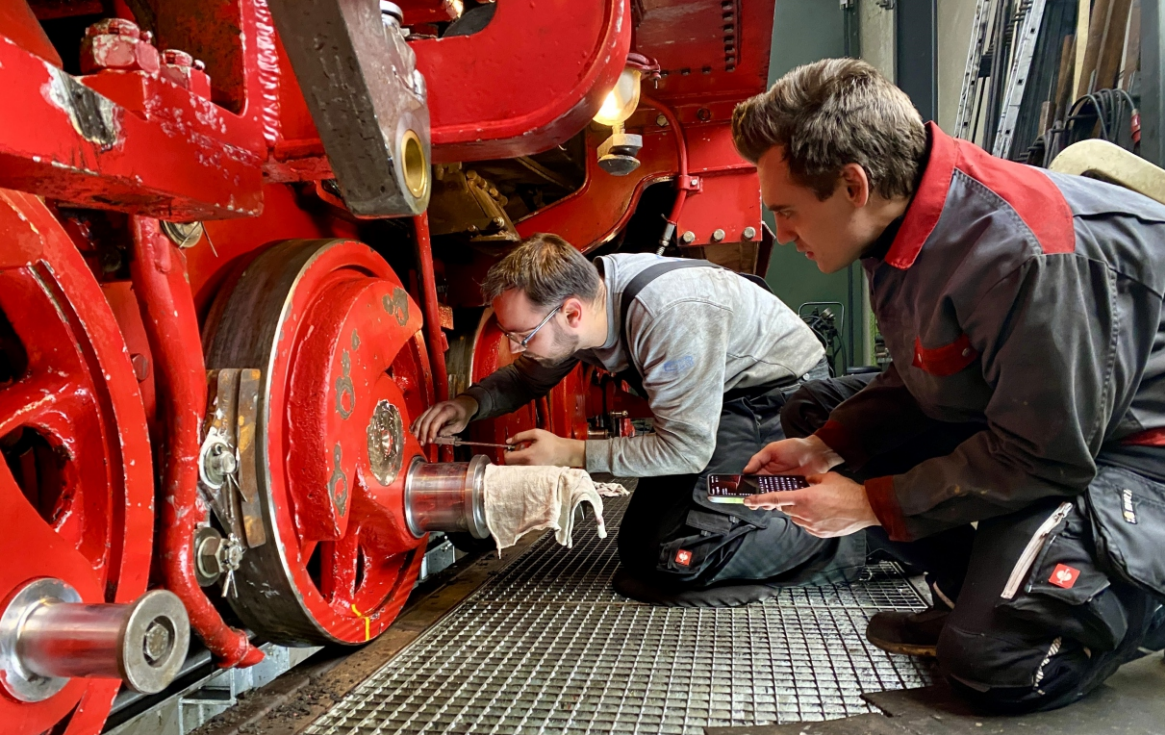
Lukas Guter und Maximilian Gerlach kontrollieren oben am 28.12.2024 die Maße der Lagerzapfen der „Berta“ 99 788. Thomas Guter und Florian Roschow kümmern sich unten am 22.03.2025 um die Aufarbeitung der Rauchkammertüre der Lok.
