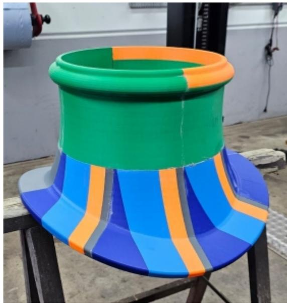
*Um zu prüfen, ob alles passt und als Form für den Nachguss, wurden die Gussteile im 3-D Druck recht farbenfroh aus Kunststoff hergestellt und auf den Kessel aufgesetzt.*
