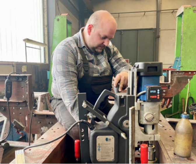
Rouven Kuhrke, hier am 4. Februar 2023 beim Ausbohren der Federstößelführungen, ist einer der wichtigen Akteure bei der Aufarbeitung der „Rosa“. (Foto: Benny Bechter)
