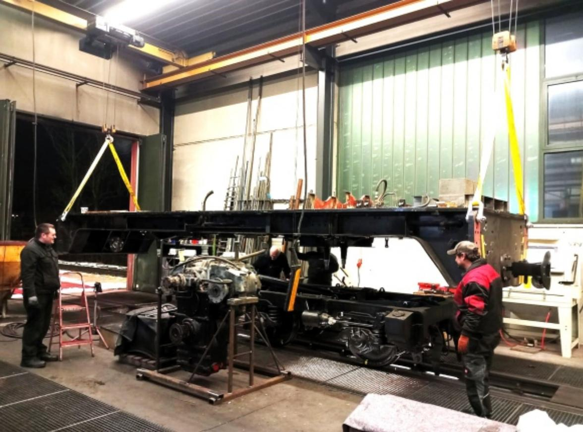
*Um den Rahmen der V51 innen besser reinigen und lackieren zu können, wurde er wieder von den Drehgestellen abgehoben. Simeon Langenbahn und Florian Roschow sind am 16. Dezember damit beschäftigt. Im Vordergrund steht das ausgebaute Sammel- und Wendegetriebe.*
