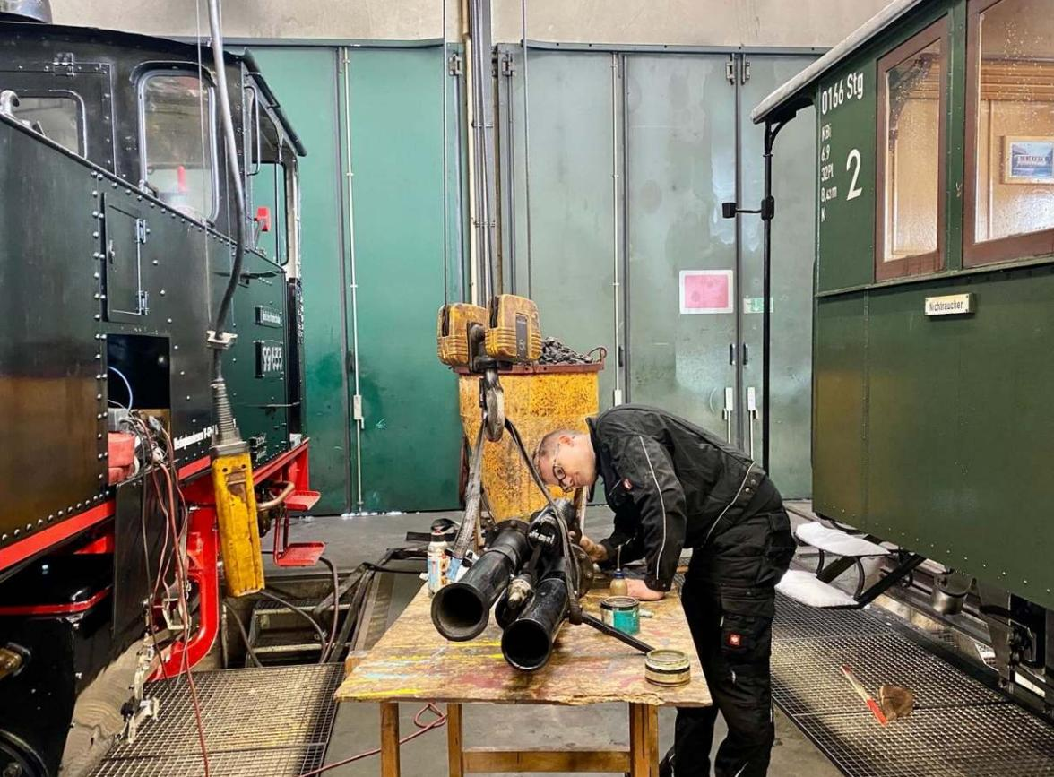
*An der 99 633 standen zwar keine größeren Arbeiten an, trotzdem galt es über den Winter einige routinemäßige Wartungsarbeiten auszuführen. Niklas Manz kümmert sich am 2. April 2022 um das Sicherheitsventil der Lok.*
