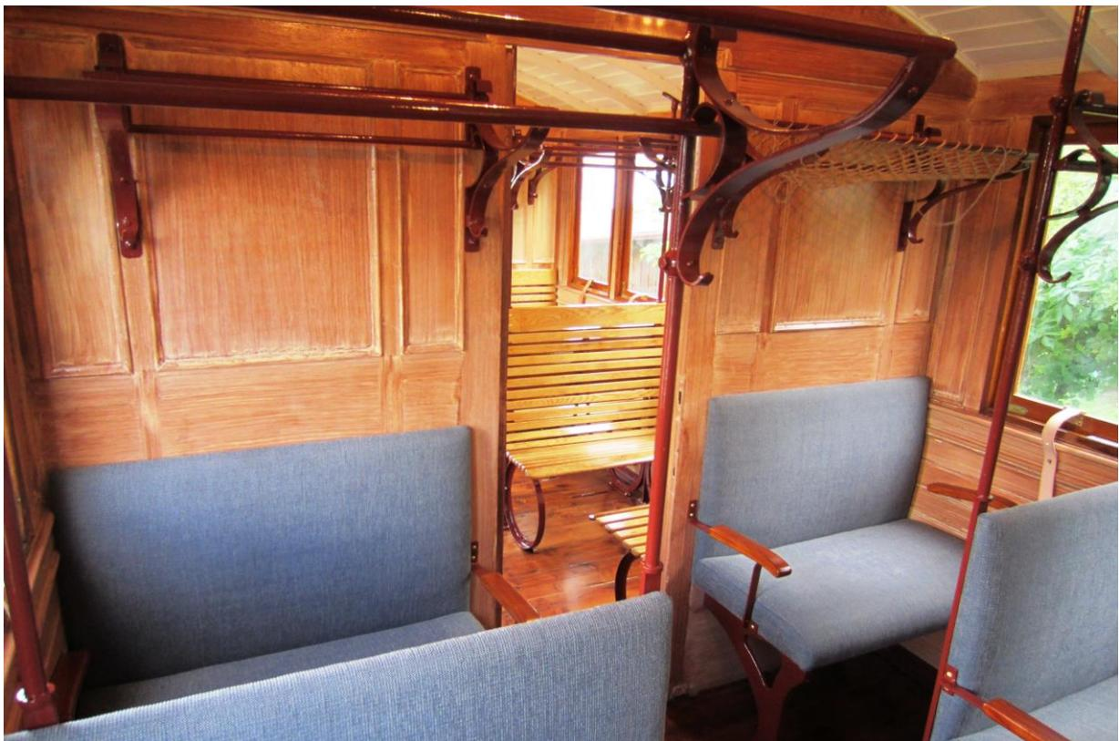
*Der zwischenzeitlich eingebaute PVC-Boden wurde entfernt und die komplette Inneneinrichtung nach historischen Vorbild nachgebaut.*
